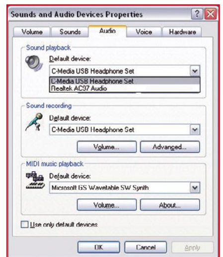
Bild 4. Nach Anschluss an den USB-Port des PCs wird der Soundkarten-Chip erkannt, man kann dann zwischen interner Soundkarte, dem Adapter und gegebenenfalls weiteren installierten Audiogeräten umschalten.
