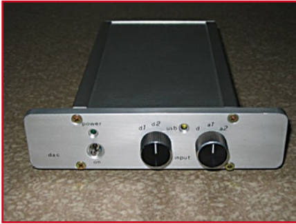
Bild 1. Der Konverter bietet eine einfache Möglichkeit, externe D/A-Wandler mit einem USB-Eingang auszurüsten (hier ein Gerät des Autors, siehe [1]).
